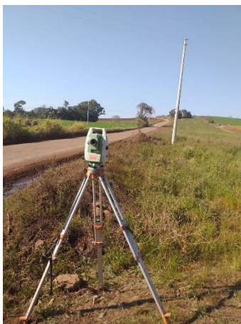
Foto1-Execução de levantamento topográfico com RTK (Base) -
